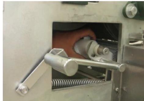
**2** Asegurar la palanca del cortador y verificar que esté correctamente ensamblado.
